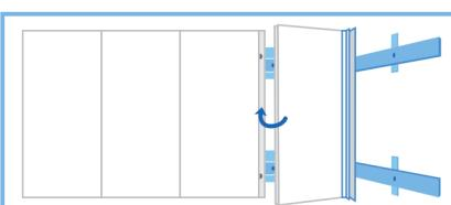
Остання в ряду панель спочатку встремлюється в паз стартового профіля або кута, а потім із зусиллям – в паз попередньої панелі. Остання панель не фіксується.
