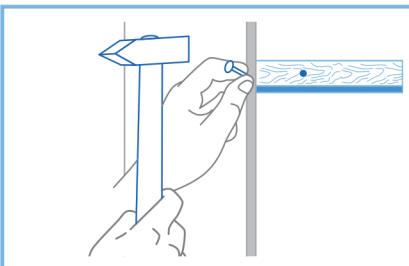
Тепер потрібно прикріпити панель ПВХ до дерев'яних брусків. Для цього ми прибиваємо скобами або саморізами панель по великій поличці для кріплення на краю панелі. Встановлюємо наступну панель. Особливу увагу потрібно приділити тому, щоб панелі прилягали максимально щільно одна до одної.
