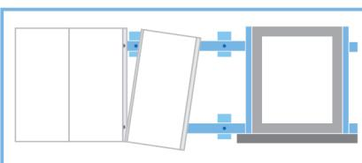
Таким чином, встановлюємо одну панель ПВХ за одною до віконного або дверного отвору або до наступного кута стіни.
