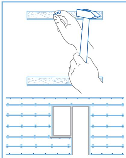
Для монтажу Вам знадобляться дерев'яні або ПВХ бруски. Вони стануть каркасом для панелей. Бруски потрібно прикріпити до стін або стелі на відстані не більше 50 см один від одного за допомогою гвинтів, шурупів або цвяхів. Якщо Ви будете монтувати панелі ПВХ під кутом до підлоги – краще розташувати бруски щільніше один до одного. Інакше короткі панелі в кутах стіни буде важко закріпити.
